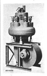
günstigen Betriebsergebnisse sind wir zur serienmässigen Herstellung von pumpenlosen Mutatoren übergegangen. Fig. 2 zeigt den 500-A-Typ L 06. Von dieser Serie haben wir bereits über 10 Stück verkauft. Fig. 3 zeigt einen pumpenlosen Mutator für 1200 A, Typ L 36. Zum Vergleich zeigt Fig. 4 einen luftgekühlten Mutator mit Pumpe. Es ist dies der Typ AL 56 für 3000 A. Man erkennt den Ventilator für künstlichen Luftzug zur Kühlung des Mutators, die luft-
