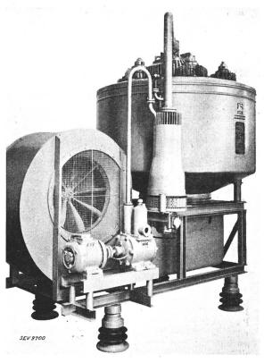
Fig. 4. Luftgekühlter Mutator mit Pumpe, Typ AL 56, für 3000 A.
