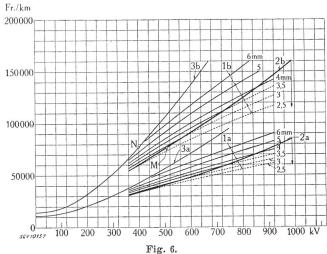
Anlagekosten von Gleichstromleitungen in Funktion der Betriebsspannung, mit Leitern, die für die Koronagrenze nach Fig. 4 dimensioniert sind
