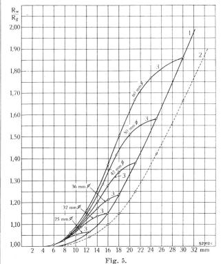
Skineffekt in Voll- und Hohlleitern bei Wechselstrom von 50 Hz
