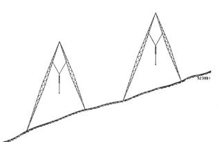
Den Schutz gegen Blitzschlag in die Leitungen bilden die Erdseile. IhreWirkung wurde für alle berechneten Leitungen dadurch nach Möglichkeit gleichgemacht, dass eine ähnliche Anordnung der Erdseile hinsichtlich Höhe über den Leitern und seitlichem Abstand derselben gewählt wurde. Die Erfahrungen haben gezeigt, dass bei genügend hoher Anordnung des Erdseiles auch die Leitungen mit Tannenbaumanordnung der Leiter gut geschützt sind.
