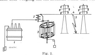
Nicholson Arc-Suppressor (1913). Transformator (Nullpunkt geerdet). 2 Kurzschluss-Solenoid-Schalter. 3 Sicherungsgestell. 4 100-kV-Fernleitung. 5 Erd-schluss (einphasiger Kurzschluss).
