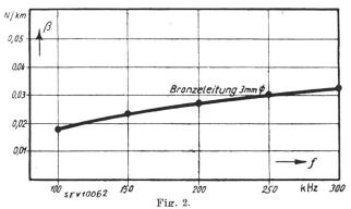
Hochfrequenz-Dämpfung einer 3-mm-Bronze-Freileitung.
