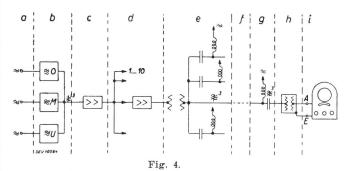
Aufbau eines Hochfrequenz-Drahtfunknetzes.
