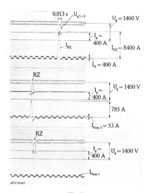
Fig. 20. Gleichspannung und Wechselstrom einer kleinen Mutatorgruppe nach Fig. 6
