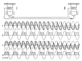
Fig. 5. Wirkungsweise des Wechselstrom-Gleichstrom und Gleichstrom-Wechselstrom-Mutators
