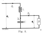
Strom-Spannungs-Gesetz von Boucherot
