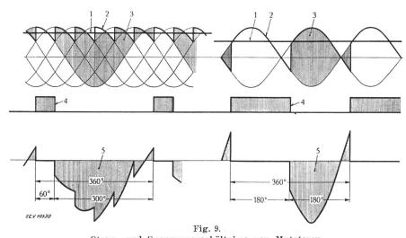
Strom- und Spannungsverhältnisse von Mutatoren
