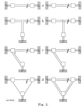
Vergleich von Uebertragungsanlagen mit Konstantstrom-und Konstantspannungs-System
