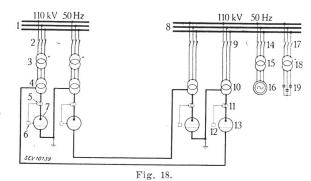
Prinzipschema einer Gleichstrom-Uebertragungsanlage Links: Sendestation. Rechts: Empfangsstation.
