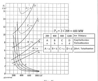
Fig. 25. Beispiel der Bestimmung der wirtschaftlich günstigsten Spannung bei Gleichstrom-Uebertragung
