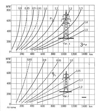
Fig. 27. Kurven gleicher, minimaler Energiepreise in Rp./kWh am Leitungsende für Drehstrom (oben) und Gleichstrom (unten) unter Voraussetzung günstiger Annahmen (Tabelle I).
