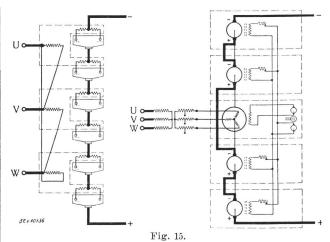
Vergleich einer grossen Mutatoreinheit mit einer Maschineneinheit
