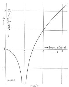
$\begin{array}{c} \textbf{Integrallogarithmus} \ y = \mathrm{li}(x). \\ \text{Verlauf des Ausgleichstromes} \ i \ \mathrm{im} \ \text{Ableiter in Funktion} \\ \text{der Zeit} \ t. \end{array}$
