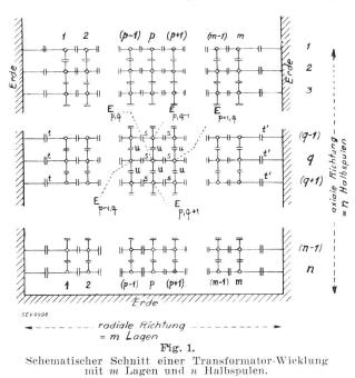
Die Spannung jeder Windung wird mit dem Symbol E bezeichnet, wobei zwei Indizes beigelegt werden, der erste für die Bezeichnung der Lage und der zweite für die Bezeichnung der Halbspule.
