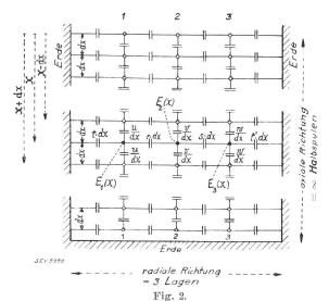
Schematischer Schnitt einer Transformator-Wicklung mit 3 Lagen und  $\infty$  vielen Halbspulen.
