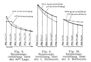
dargestellt (Fig. 8, 9, 10, ausgezogene Kurven). Eine Kurve ergibt die Spannung in der  $m^{\text{ten}}$  Lage, eine andere in der ersten Halbspule und eine weitere in der zweiten Halbspule. Die Spulenverbindung bringt nun die Drähte (m), (1) und (m), (2) auf einen gemeinsamen Potentialwert, der als derjenige Punkt aus der Kurve Fig. 8 zu wählen ist,
