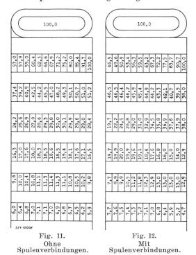
Transformator 77283/24420 V, 2500 kVA. Berechnung der kapazitiven Spannungsverteilung in der Oberspannungswicklung als 3-Lagenwicklung betrachtet, mit Schutzring, innere Unterspannungswicklung und äussere Regulierwicklung als geerdet angenommen. Stetiger Spannungsverlauf als Lösung der Differentialgleichungen ermittelt.
