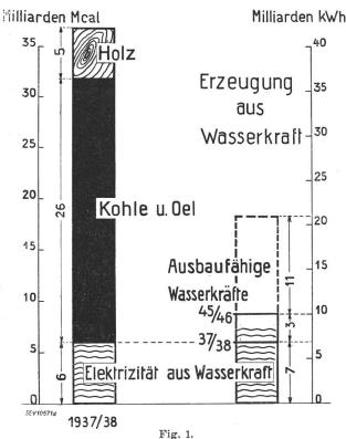
Gesamter Energieumsatz (links) und Erzeugung aus Wasserkraft (rechts)
