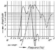
Fig. 17. Filterkurven für die Erzeugung einer Klangfarbe mit Formanten und einer andern mit stark ausge-prägten hohen Teiltönen
