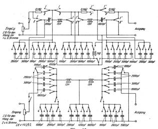
Fig. 15. Schaltanordnung für die Einstellung verschiedener Filter an der Orgel mit Auswahlschaltung
