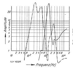
Fig. 16. Filterkurven für Filterkurven für die Erzeugung zweier Klangfar-ben mit Forman-ten, die, auf ver-schiedene Stim-men verteilt, sich gut im mehrstim-migen Satz er-ginzen gänzen
