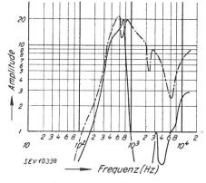
Fig. 18. Filterkurven für die Erzeugung zweier verschie-dener Klangfar-ben mit hohen Teiltönen, die, im mehrstimmi-gen Satz auf ver-schiedene Stim-men verteilt, gut zueinander passen Filterkurven für
