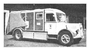
Fig. 2. Elektrofahrzeug für die Kehrichtabfuhr max. Nutzlast 2820 kg
