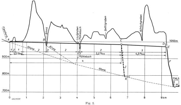
Längenprofil der Kraftwerkanlage Mörel
