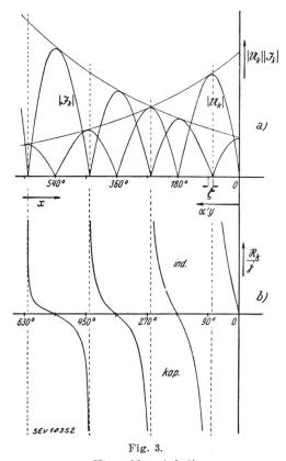
Kurzschluss ( $\mu > 0$ ). a) Strom- und Spannungsverteilung.
