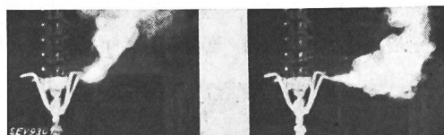
Fig. 4. Wanderung des Lichtbogenstiels vom Hornknick an das Hornende ( I = 700 A).
