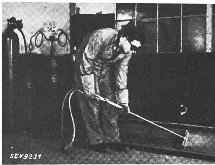
Fig. 4. Ausführung des Absengens.
