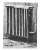
Beschreibung: Elektrischer Heizofen gemäss Abbildung. Wasserbehälter aus Kupferblech, mit eingebautem Heizelement. Rippen aus Aluminiumblech zur Vergrösserung der Heizfläche. Apparatestecker für den Anschluss der Zuleitung.
