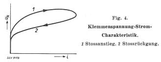
Erläuterung: Diese Charakteristik kann entweder direkt mit dem Oszillographen aufgenommen oder aus den gleichzeitig über, der gleichen Zeitaxe aufgenommenen Oszillogrammen der Ableiterklemmenspannung und des durch den Ableiter fliessenden Stoßstromes konstruiert werden.
