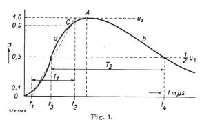
Die charakteristischen Grössen der Stoßspannung. T<sub>1</sub> Frontdauer. T<sub>2</sub> Halbwertdauer. u<sub>s</sub> Scheitelwert.
