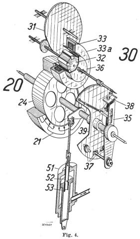
Frequenzsteuersystem mit elektromagnetischer Stabilisierung.
