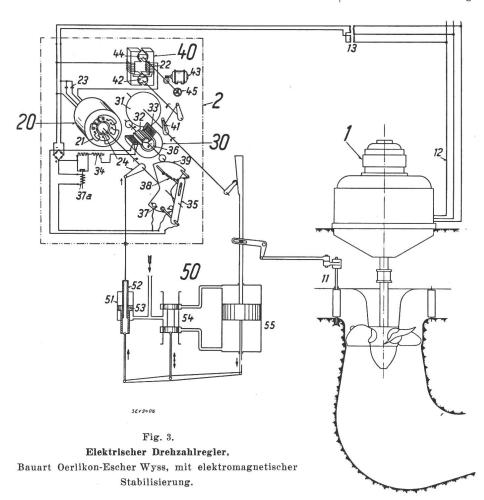
Frequenzmeßsystem 20 (Fig. 3 und 4) die Frequenz gemessen. Bei den kleinsten Abweichungen vom Sollwert betätigt die Drehtrommel 24 des Meßsystems ein Vorsteuerventil 51 mit Differentialkolben 53. Dieser überträgt — wie bei dem Fliehkraftregler — die Steuerbewegung auf das Hauptsteuerventil 54, das den Hauptservomotor 55 steuert. Von diesem erfolgt dann die Betätigung der Regulierorgane 11 der Turbine, z. B. Düsennadel, Leitschaufeln, Verstellpropeller bei Wasserturbinen.
