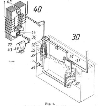
Elektrohydraulische Stabilislerung mit Drehzahlverstellungs- und Statikeinstellungseinrichtung.
