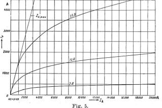
Für eine 2-A-Sicherung steigt beispielsweise in einem 10-kV-Netz, mit einer Kurzschlussleistung von 300 000 kVA, der Verdampfungsstrom nicht höher als auf ca. 520 A. Der Vorteil der Sicherung gegenüber dem Schalter tritt dadurch klar hervor. Die vielen durchgeführten Versuche ergaben, dass die berechneten Werte mit den gemessenen sehr gut übereinstimmen.
