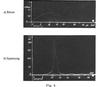
Kathodenstrahloszillogramme eines Durchschmelzversuches eines Silberdrahtes in Quarzsand bei Stoss.
