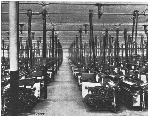
Fig. 2. Websaal mit Transmissionsantrieb.
