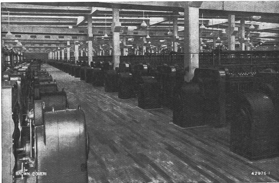
Fig. 7. Ringspinnmaschinen mit Nebenschluss-Kommutatormotoren und Spinnreglern.
