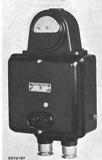
Fig. 1 (links). Betriebsstromanzeige am Relais. Aufbau-Ampèremeter.
