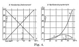
Drehstrom-Schleifringankermotor mit Schlupfregulierung. P abgegebene Leistung,  $V_1$  Verlust in der Rotorwicklung,  $V_a$  Verlust im Regulierwiderstand,  $V = V_a + V_1$  Gesamtverlust im Sekundärkreis.
