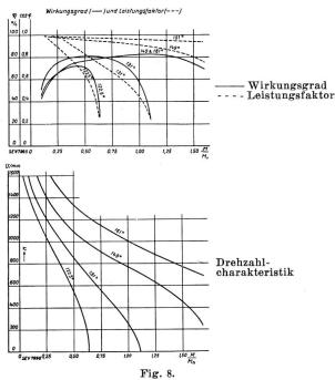
Drehstrom-Serie-Kommutatormotor. 5,5/22 kW, 250...1000 U/min.
