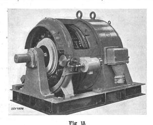
Drehstrom-Serie-Kommutatormotor. 130 kW, 725...435 U/min, zum Antrieb eines Unterwindgebläses.
