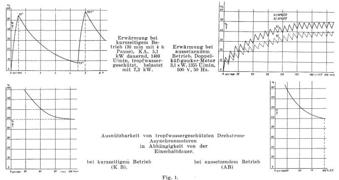
Erwärmung und Ausnutzbarkeit eines Motors bei verschiedenen Belastungsarien,
