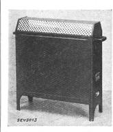
Beschreibung: Elektrischer Heizofen gemäss Abbildung. Widerstandsdraht auf acht übereinander angeordnete, vom Aluminiumgehäuse isolierte Metallrahmen gewickelt. Gehäuse unten und oben durch Gitter bzw. perforiertes Blech derart abgeschlossen, dass gute Ventilation möglich. Isolierhandgriffe. Apparatestecker für den Anschluss der Zuleitung.
