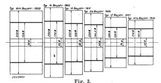
Der Materialaufwand 1900—1935. Entwicklung der Blechpaketabmessungen des Drehstromkäfiganker-Motors 2,2 kW, 4polig, 50 Hz.
