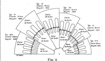
Die Entwicklung des magnetischen Kreises seit 1900. Entwicklung der Blechschnitte des Drehstromkäfiganker-Motors 2,2 kW, 4polig, 50 Hz. Baujahr 1900—1935.
