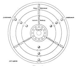
Fig. 13. Schaltschema des Rotorstromkreises des Combi-Motors.
