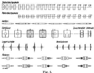
Der Baukasten für elektrische Maschinen.
