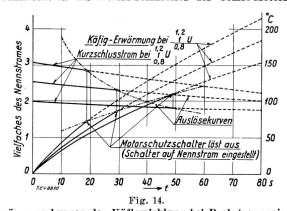
Erwärmungskurven der Käfigwicklung bei Drehstromspeisung des Stators und festgebremstem Rotor.
