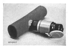
Beschreibung: Heizkörper für den Einbau in die Kühlwasserleitung von Automobilmotoren (Gummischlauch zwischen Motor und Kühler) gemäss Abbildung. Heizkörper mit Metallgehäuse in Gummischlauch eingebaut. Zuleitungen in Metallrohr durch Schlauchwandung geführt und mit starr angebrachtem 6-A-250-V-Stecker mit Erdkontakt verbunden. Vorderteil des Steckers durch Messinghülse mit Deckel geschützt. Die Zuleitung wird mit einer Kupplungssteckdose mit Erdkontakt angeschlossen.
