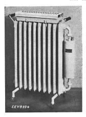
Beschreibung: Elektrischer Heizofen gemäss Abbildung. Stahlradiator, bestehend aus zehn Elementen, mit Wasser gefüllt. Beheiztes Durchflussrohr seitlich angebaut. Expansionsgefäss auf dem Radiator dient zugleich zum Verdunsten von Wasser.
