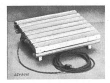
Beschreibung: Heizschemel aus Hartholz gemäss Abbildung,  $300 \times 350$  mm gross, Höhe durch Umlegen der Füsse verstellbar. Heizwiderstand zwischen Lignatplatten angeordnet. Netzanschluss mit zweiadriger, mit Stecker versehener verseilter Schnur.
