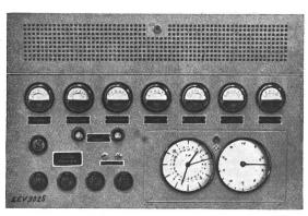
Fig. 6. Vorderansicht der vollständigen Quarzuhr.
