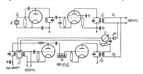
Fig. 2. Schaltung einer Frequenzteilung 100:1 mit dem Regelverfahren nach Rohde.
