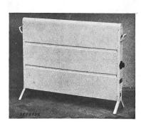
Beschreibung: Elektrischer Heizofen gemäss Abbildung. Widerstandsspiralen auf Eternitplatte befestigt und in Blechgehäuse eingebaut. Eternitplatte durch keramisches Material vom Gehäuse distanziert. Regulierschalter ermöglicht den Betrieb des Ofens mit ½, 2% und ³/3 der Heizleistung. Apparatestecker für den Anschluss der Zuleitung.
