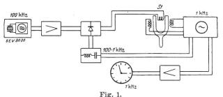
Grundprinzip der phasengesteuerten Frequenzteilung in einer Stufe.
