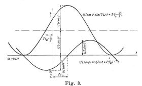
eine schwingt mit dem Scheitelwert  $UI\cos\varphi$  um den Mittelwert  $UI\cos\varphi$ ; ihr Nullphasenwinkel ist  $\left(2\,\varphi_u-\frac{\pi}{2}\right)$ . Die zweite Schwingung eilt der ersten wegen ihres Nullphasenwinkels  $2\,\varphi_u$  um 90 ° nach und hat den Scheitelwert  $UI\sin\varphi$ ; ihr zeitlicher Mittelwert ist Null. Der zeitliche Mittelwert beider Schwingungen, also der gesamten Leistung, ist daher  $UI\cos\varphi$ .
