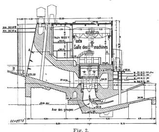
Salle des machines de l'usine du Verbois. Coupe transversale. Alternateur 27 500 kVA. Turbine 23 200 kW pour  $H_{\rm m}=20.80$  m et Q=127.50 m³/s.
