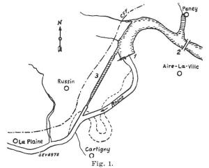
Plan de situation de l'usine du Verbois. 1 Usine et barrage (retenue max. 368,6 m). 2 Pont de Peney. 3 Canal de navigation.
