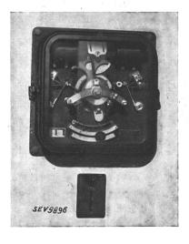
Fig. 3. Fernleistungs-Impulsregler von Brown Boveri
