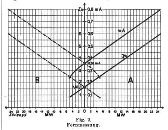
In Fig. 2 ist der Zusammenhang zwischen übertragener Leistung und der Impulszahl/Sekunde (I/s) wiedergegeben. Umstellungen von beispielsweise Energieabgabe (A) auf Bezug (B) können am Sendeapparat und am Fernleistungsregler durch Umschaltungen in kürzester Frist ausgeführt werden. Die relativ kleinen Impulszahlen und die ausserordentlich geringen Stromstärken im Gleichstromkreis ohne Beeinflussung der Fernmessung zu verstärken und für die Tur-
