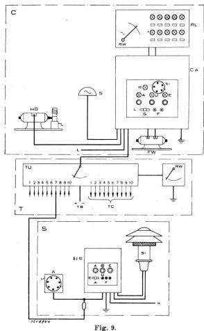
Schema einer Sirenenfernsteueranlage, System Landis & Gyr. C Kommandostelle. Leitungsumschalter. CA Kommandostelle.
