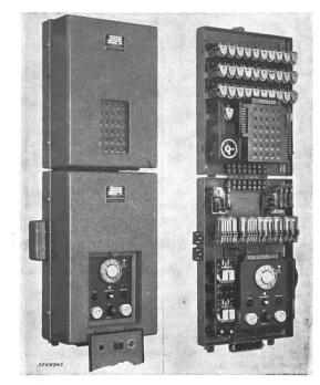
Fig. 10. Kommando- und Rückmeldegerät einer Sirenensteueranlage.
