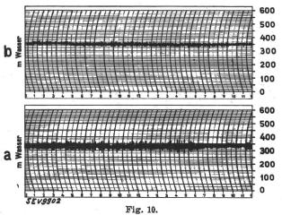
Löntschwerk. Druckdiagramm Rohrleitung 4.
