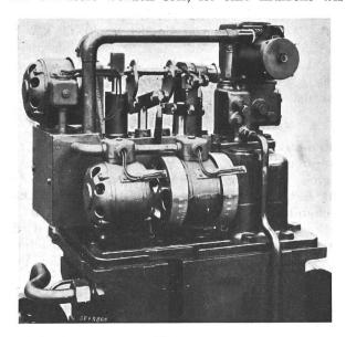
Fig. 9. Rückführapparat des Steuerreglers.
