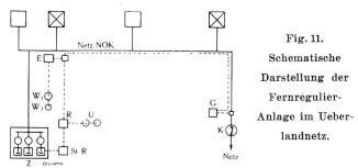
⊠Erzeugerwerke. □ Verbraucher. Z Zentrale Löntsch. K Kupplungsstelle beider Netze. G Geber. E Empfänger. W Wattmeter. R Röhrenrelais. U Umformergruppe 300 V, 2 kW. St R Steuerrelais PB 2/0.
