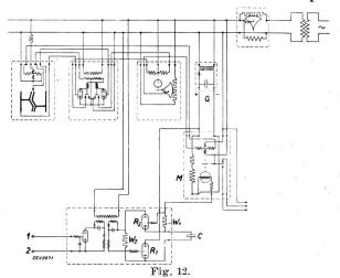
Prinzipschema der indirekt wirkenden Impulsregulierung. G Gleichstromquelle. M Reglermeßsystem. R1, R2 Verstärkerröhren. W1, W2 Lade-bzw. Entladewiderstand.
