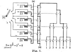
Dreistellige, gesicherte Auswahlschaltung nach dem Potenzgesetz mit der Basis 2 (Dualschaltung). Z Auswahlelemente (Wählerstellungen). S Gesamtzahl Stromkreise (Signale).
