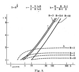
Auswahlgeschwindigkeit und Kontaktaufwand von Schaltungen nach dem Potenzgesetz.
