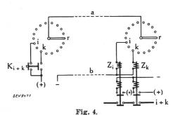
Grundsätzliche Anordnung einer Fernsteuereinrichtung mit mehrstelligem Auswahlzeichen.
