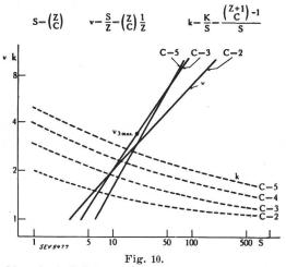
Auswahlgeschwindigkeit und Kontaktaufwand von Schaltungen nach dem Kombinationsgesetz.
