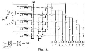
Zweistellige, durch eine Zählschaltung gesicherte Auswahlschaltung nach dem Kombinationsgesetz, mit natürlicher Kontaktfolge.
