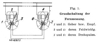
Ein zweites gleiches Elektrodynamometer 3 ist das Empfangsinstrument. Ihre Feldwicklungen 2 und 4 werden aus derselben Wechselstromquelle gespeist; sie können unter sich in Reihe oder parallel zueinander geschaltet sein. Die beiden Drehspulen 5 und 6 sind durch zwei Leiter zu einem Stromkreis für sich vereinigt.
