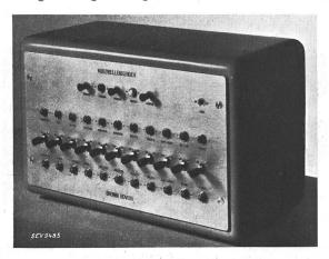
Fig. 18. Kommandogerät der JK-Fernsteuereinrichtung nach Fig. 16.
