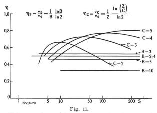
Wirkungsgrad von Schaltungen nach dem Potenz- und Kombinationsgesetz. B Basis des Potenzgesetzes, C Kombinationsklasse. v Auswahlgeschwindigkeit,  $\eta$  Wirkungsgrad.
