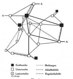
Fig. 1. Elektrizitäts-Versorgungsbetrieb mit fernwirktechnischen Einflusslinien.
