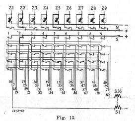
Auswahlschaltung nach dem Kombinationsgesetz. Kombination von 9 Elementen zur zweiten Klasse mit zyklischer Vertauschung der Stromkreise.
