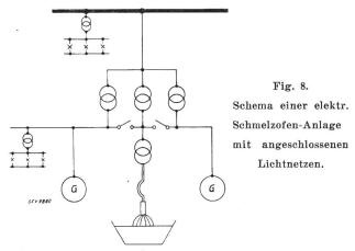
nicht erschöpft; die Wirksamkeit dieser Massnahme könnte aber durch die Aufstellung besonderer Kompensatoren beliebig erhöht werden, womit gleichzeitig eine evtl. wünschbare Verbesserung des Leistungsfaktors des Ofens, bzw. des Fabrikbetriebes erreicht wird.
