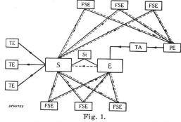
Schematische Darstellung eines modernen Polizeifunknetzes mit den Verbindungsmöglichkeiten.
