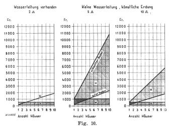
Kosten des Ueberspannungsschutzes in Niederspannungsnetzen. H im Haus. M am Mast.
