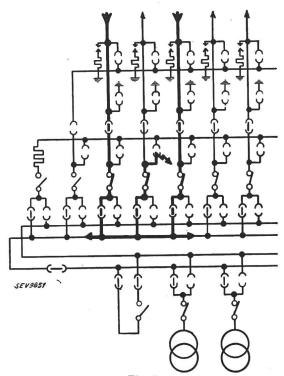
Fig. 6. Störung im 8-kV-Teil des Unterwerks A durch Schalterüberspannungen.
