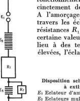
construction des parafoudres. Son fonctionnement peut s'expliquer succinctement de la manière suivante: A l'amorçage le courant s'écoule à travers les éclateurs  $E_1$  et  $E_2$  et les résistances R<sub>1</sub> et R<sub>2</sub>. S'il dépasse une certaine valeur susceptible de donner lieu à des tensions résiduelles trop élevées, l'éclateur E3 s'amorce à son
