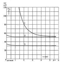
Fig. 5. Variation de la tension d'amorcage en choc Ua en fonction du temps t qui s'écoule jusqu'au moment de l'amorçage. 1 parafoudre tubulaire du type courant. 2 parafoudre 15 kV. combiné à tube d'extinction de la fig. 4. 3 parafoudre 11 kV, à extinction en cascade de la fig. 6.
