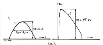
Contrôle du pouvoir d'écoulement du parafoudre à extinction en cascade.
