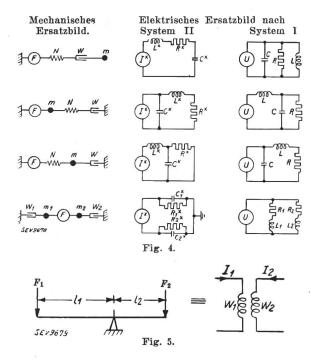
tragung ein elektrisches Ersatzschema angeben (Fig. 5). Die Kräftegleichung des Hebels lautet:
