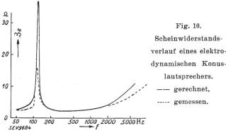
Der Wirkungsgrad  $\eta$  ist gleich dem Verhältnis der Wirkleistung zur gesamten, der Triebspule zugeführten Scheinleistung
