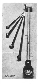
Beschreibung: Gerät gemäss Abbildung für den Anschluss transportabler Maschinen an Drehstromfreileitungen mit Nulleiter. Es besteht aus vier Klemmen, einem Sicherungskasten, einer Steckdose und Verbindungsleitungen. An Leitungsstangen, in deren Nähe ein Netzanschluss in Frage kommt, werden zwei Halter fest montiert. An diesen kann das Gerät leicht befestigt werden.
