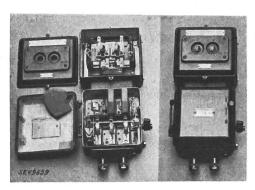
Beschreibung: Berührungsschutzschalter gemäss Abbildung, bestehend aus einem dreipoligen Motorschutzschalter mit direkt beheizten thermischen Auslösern und einer aufgebauten Ueberwachungseinrichtung mit 2 Druckkontakten und 2 Vorschaltwiderständen. Apparategehäuse aus Leichtmetallguss.
