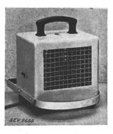
Beschreibung: Heizofen mit Ventilator gemäss Abbildung. Widerstandsspiralen senkrecht nebeneinander angeordnet. Dahinter befindet sich ein Ventilator, angetrieben durch Einphasen-Seriemotor. Netzanschluss mit fest angeschlossener dreiadriger Gummiaderschnur. Einpoliger Kipphebelschalter sowie eine Temperatursicherung eingebaut. Letztere soll die Heizung unterbrechen, sobald am Ofen infolge unge-
