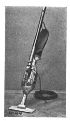
Beschreibung: Elektrischer Staubsauger gemäss Abbildung. Zentrifugalgebläse, angetrieben durch gekapselten Einphasen-Seriemotor. Motoreisen vom Gehäuse isoliert. Führungsstange aus Holz.
