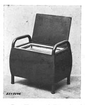
Beschreibung: Elektrischer Heiz- und Dörrofen gemäss Abbildung, in der Hauptsache aus Blech hergestellt. Heizwiderstand unten im Kasten angeordnet. Eingebauter Schalter ermöglicht Regulierung der Heizleistung in drei Stufen. Der Ofen ist mit einem Dörreinsatz mit vier Gittern versehen. Zum Dörren soll der Ofen nur auf Stufe 1 (300 W) verwendet werden. Apparatestecker für den Anschluss der Zuleitung.
