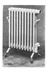
Beschreibung: Elektrischer Heizofen gemäss Abbildung. Radiator, bestehend aus 10 Elementen, mit Wasser gefüllt. Heizkörper unten eingebaut. Regulierschalter ermöglicht den Betrieb des Ofens mit der halben oder ganzen Heizleistung. Apparatestecker für den Anschluss der Zuleitung.
