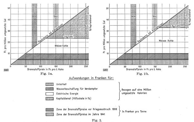
Raumheizung bei normalen Wassertemperaturen nach B. 1550 Vollbetriebsstunden pro Jahr. a Energiepreis 3 Rp./kWh. b Energiepreis 5 Rp./kWh. Unter der Bezeichnung Cal sind kcal verstanden.
