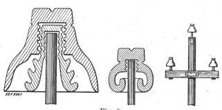
Fig. 8. Oelisolatoren und Mastkopf der Leitung Lauffen-Frankfurt.
