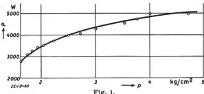
Zusammenhang wischen der elektrischen Leistung P in Watt und dem Druck des Belastungsstromes p in kg/cm².
