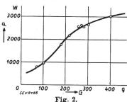
Zusammenhang zwischen der elektrischen Leistung P in Watt und dem Elektrodenvorschub G in Gramm.
