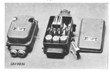
Beschreibung: Dreipolige Motorschutzschalter gemäss Abbildung, in Gussgehäuse. Indirekt beheizte thermische Auslöser in allen drei Polen. Auslöser mit Schraubenzieher verstellbar. Abwälzkontakte aus silberplattiertem Kupfer.
