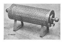
Beschreibung: Elektrischer Heizofen gemäss Abbildung. Heizkörper aus Widerstandsdraht und Asbestschnur in 400 mm langem Gehäuse aus perforiertem Blech. Füsse aus Flacheisen. Apparatestecker für den Anschluss der Zuleitung.
