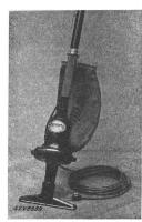
Beschreibung: Elektrischer Staubsauger gemäss Abbildung. Zentrifugalgebläse, angetrieben durch Einphasen-Seriemotor. Motor ventiliert (separater Ventilator). Motor und Gebläsegehäuse aus Isolierpreßstoff, Führungsstange aus Holz.
