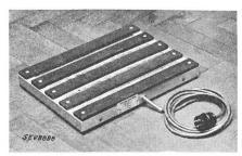
Beschreibung: Elektrischer Fusswärmer gemäss Abbildung. Flacher Heizwiderstand mit Glimmerisolation zwischen zwei Blechen.  $300 \times 400$  mm grosser Metallrahmen. Hartholzleisten mit Asbestunterlagen auf der Oberseite, Eternitplatte
