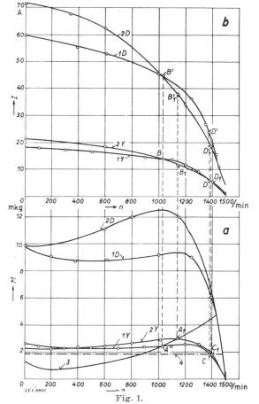
$\begin{array}{c} \textbf{Motor 380 V, 7 kW.} \\ a \text{ Drehmomente (unten). } b \text{ Anlaufströme (oben).} \\ \textbf{ehmoment bzw. Anlaufstrom des Doppelnutmotors bei} \end{array}$
