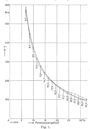
Spezifischer Widerstand eines Kiessandgemisches in Funktion des Porenwassergehaltes.
