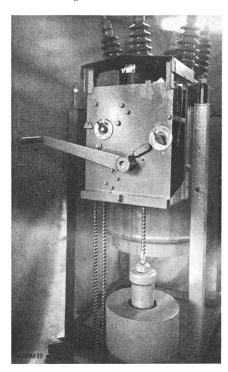
Fig. 7. Wiedereinschaltvorrichtung. Vorderansicht bei aufgeklapptem Gehäuse (Sprecher & Schuh).
