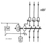
Fig. 5. Elektromechanisches Schaltbild einer Wiedereinschaltvorrichtung mit Gewichtsantrieb (Sprecher & Schuh).
