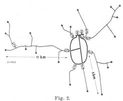
Kabelnetz (dicke Linien) mit angeschlossenen Freileitungen (dünne Linien).
