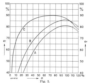
Wirkungsgradkurven  $(\eta)$  von Turbinen-Generator-Gruppen in Funktion der Belastung P.
