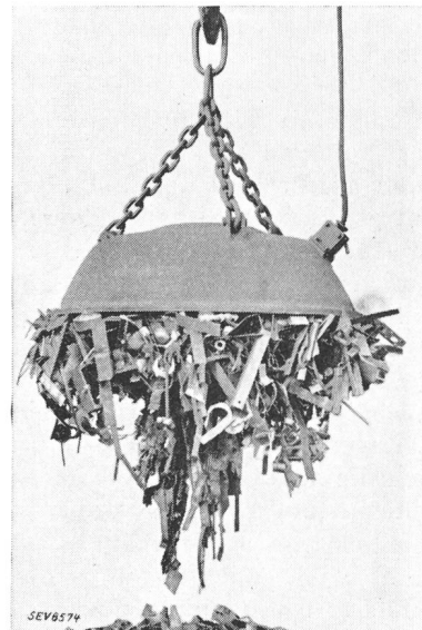
Fig. 5. Lasthebemagnet. Die Windungsisolation besteht aus Aluminium-Oxyd.
