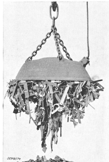
Fig. 5. Lasthebemagnet. Die Windungsisolierung besteht aus Aluminium-Oxyd.
