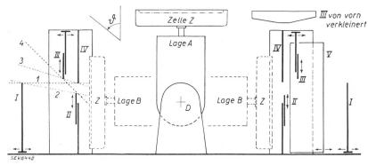
Fig. 1. Gerät zur cos-fehlerfreien Bestimmung der Horizontalbeleuchtung.
