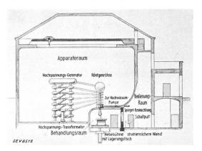
Fig. 1. Schema der Röntgen-Bestrahlungsanlage für 1 Millon V Betriebsspannung.
