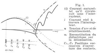
Mais si le courant qui vient de s'annuler reste nul, même un instant très court, au lieu de continuer à passer à nouveau (dans l'autre sens, cette fois), une tension apparaît aux bornes de l'interrupteur, tension fournie par le réseau, et due aux forces électromotrices de selfinduction et aux charges des capacités disséminées sur toute son étendue. Et nous assistons maintenant à une véritable course entre la tension aux bornes et la rigidité diélectrique de l'espace entre contacts.
