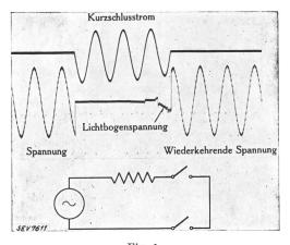
Fig. 1. Schleifenoszillogramm einer Kurzschlussabschaltung.
