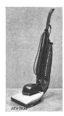
Beschreibung: Elektrische Staubsaugergemäss Abháldung. Zentrifugalgebläse sowie eine über den Saugöffnungen angebrachte Walze mit Klopfrippen und Bürsteneinsätzen durch ventilierten Einphasen-Seriemotor angetrieben. Kleine Glühlampe im Gehäuse eingebaut.
