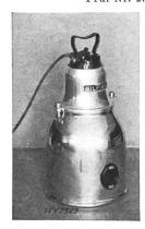
Beschreibung: Elektrische Staubsauger gemäss Abbildung. Zweistufige Zentrifugalgebläse, angetrieben durch Einphasen-Seriemotoren. Apparate mit Schlauch, Führungsrohren und verschiedenen Mundstücken zum Saugen und Blasen verwendbar.
