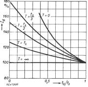
Fig. 2. Erforderlicher Dauerstrom  $I_d$  in Abhängigkeit der relativen Einschaltzeit  $t_a/t_s$ .
