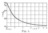
Nutzbrems-Doppelspule einer Einphasen-Lokomotive, Erforderlicher Dauerstrom  $I_d$  in Abhängigkeit der Zeitkonstanten T im Schnellzugbetrieb Luzern-Chiasso-Luzern. 100 % = Stromstärke auf 27 % Gefälle.
