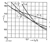
Fig. 3. Erforderlicher Stundenstrom  $I_h$  in Abhängigkeit der relativen Einschaltzeit  $t_a/t_s$ .
