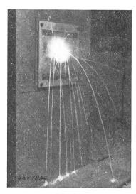
Fig. 1. Stehflammbogenbildung an einer 6 A-500 V-Schmelzsicherung bei der Ueberlastbarkeitsprüfung mit dem 5fachen Nennstrom.
