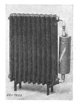
Beschreibung: Zentralheizungsradiator mit elektrischem Heizkörper gemäss Abbildung. Die 10 Stahlblechelemente, in die Wasser eingefüllt wird, weisen ca. 2 m² Oberfläche auf. Das Durchflussrohr des Heizkörpers ist aussen emailliert und darüber mit dem als Heizwiderstand dienenden, leitenden Anstrich versehen.
