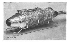
Beschreibung: Elektrische Staubsauger gemäss Abbildung. Zentrifugalgebläse angetrieben durch Einphasen-Seriemotoren. Apparate mit Schlauch, Führungsrohren und verschiedenen Mundstücken zum Saugen und Blasen verwendbar.
