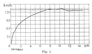
Anfahrdiagramm einer 2-D-2-Lokomotive von 2900 kW Stundenleistung mit einer Anhängelast von 534 t.
