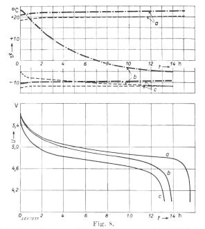
Verlauf von Spannung (U) und Temperatur (θ) bei Entladung der Batterie mit 1,78 A.
